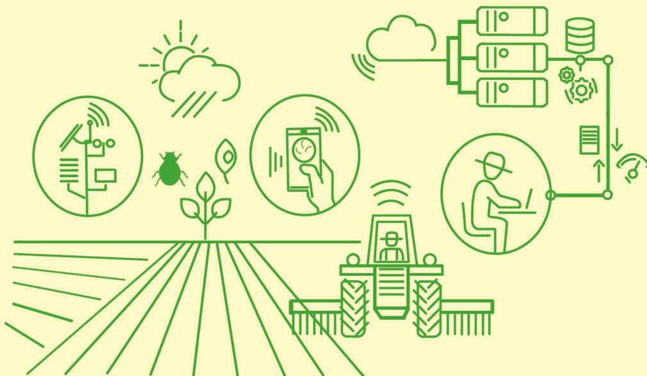
I DSSs sono piattaforme informatiche che raccolgono, in tempo reale, dati colturali tramite sensori e strumenti di scouting (1), organizzano questi dati in sistemi cloud (2), li interpretano per mezzo di tecniche avanzate di modellistica e big data (3), e li integrano in modo automatico producendo informazioni, allarmi e supporti alle
